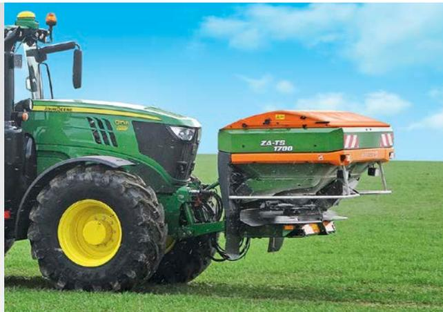
Фронтальный распределитель с соответствующей системой освещения для движения по общественным дорогам
