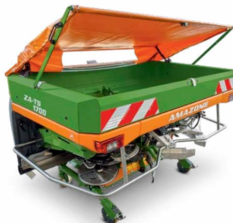
Защитный откидной тент, в положении для технического обслуживания, для удобной очистки изнутри
