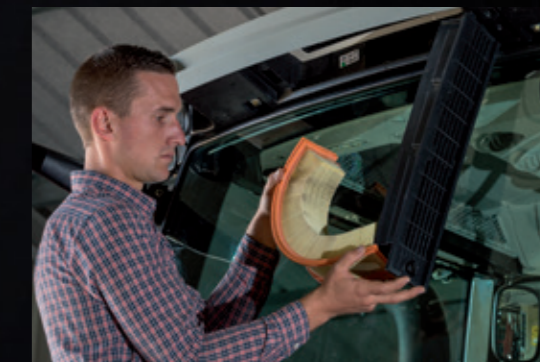
Filtr powietrza kabiny można łatwo wymontować w celu wyczyszczenia.
