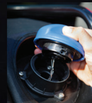
Zbiornik płynu AdBlue® usytuowano w doskonale przemyślany sposób, aby poprawić jego izolację przy niskich i wysokich temperaturach. Napełnianie obu zbiorników jest bezpieczne i wygodne.
